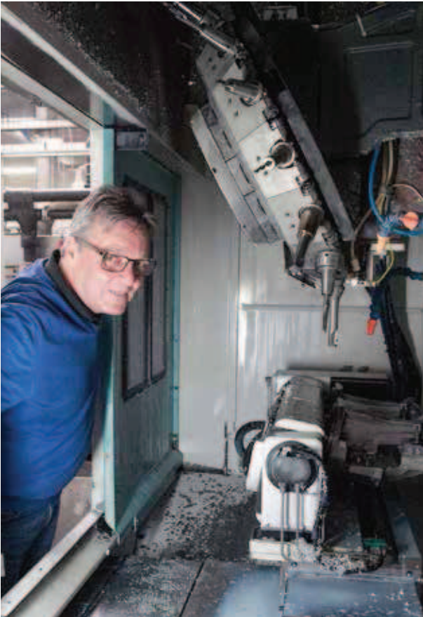
Klingel-Mitarbeiter Roland Mitschele wirft einen prüfenden Blick in die Maschine: Das Bohrerergebnis stimmt, Späne haben nicht für Unrundheiten an den Werkzeugen gesorgt.
