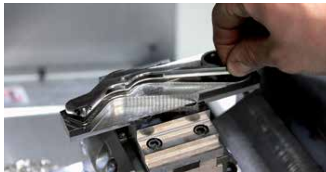
Die Griffstücke lassen sich nach dem Fräsvorgang per Hand vom restlichen Metallblock lösen.
