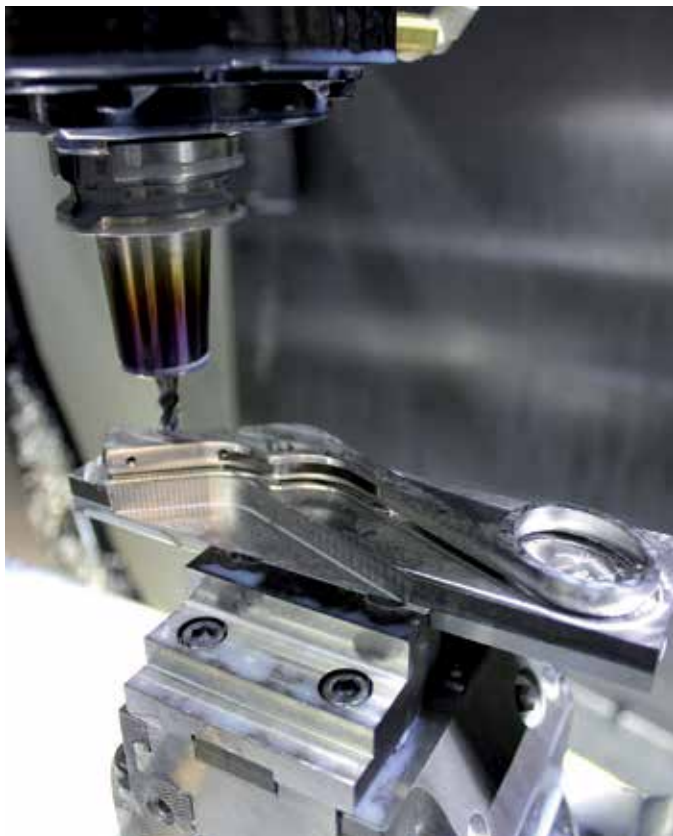
Die Operationsstanzen werden auf der Brother Speedio S500X1 aus dem Vollen gefräst. Dank der guten Harmonie von Brother und i-Machining konnte die Fräszeit deutlich reduziert werden.
