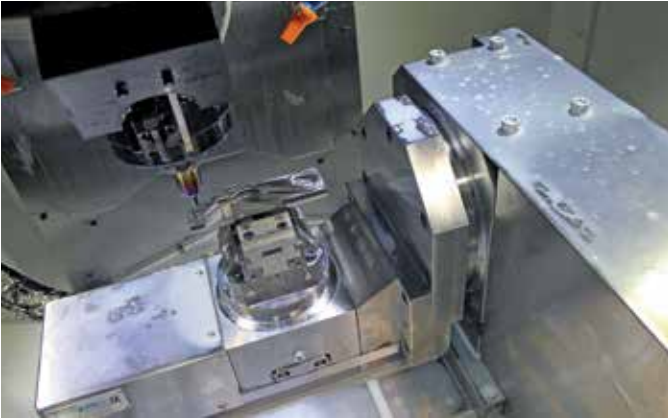
Beide Brother-Maschinen verfügen über eine 4./5. Achse (Rundtisch) der Firma Detlev Hofmann. Damit kommt das Werkstück sehr nah an das Dreh-Schwenk-Zentrum, und man geht so gut wie keine Kompromisse bei der Genauigkeit ein.
