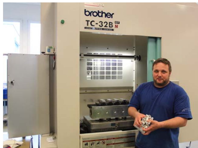
David Gerber, CNC-Programmierung und Teamleiter bei der Hans Kurt AG, vor einem Brother-BAZ vom Typ Drehpalettenmaschine TC 32BN QT mit einem 40-Platz-Werkzeugmagazin; die Palette ist mit einem Mehrfachspannsystem versehen.
