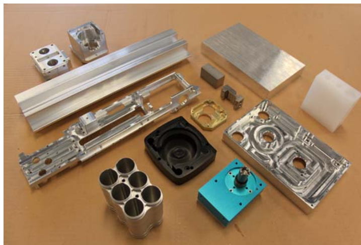
Auszug aus dem bei Hans Kurt AG zu fertigenden Teilespektrum; die teilweise im Roh- und im Fertigungszustand zu sehenden Werkstücke bestehen aus Stählen, Aluminium-Werkstoffen und Kunststoff.
